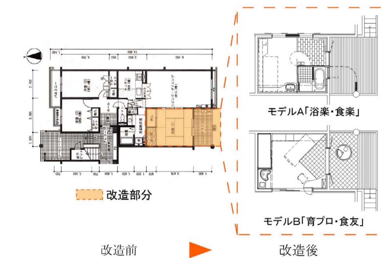
図1 モデルA・B 図面
